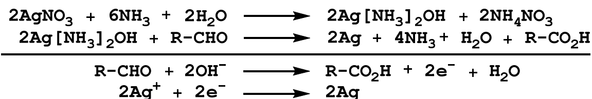
図4-3 アルデヒド類を用いた銀鏡反応
